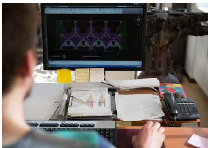
Ci-dessus : Conception d'une fiche de taille à l'aide d'un outil de CAO/DAO. © Jérôme Dorkel, Strasbourg Eurométropole
